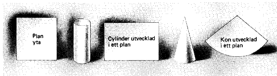
Bild 5.1 Konens och cylinderns utvecklade ytor
