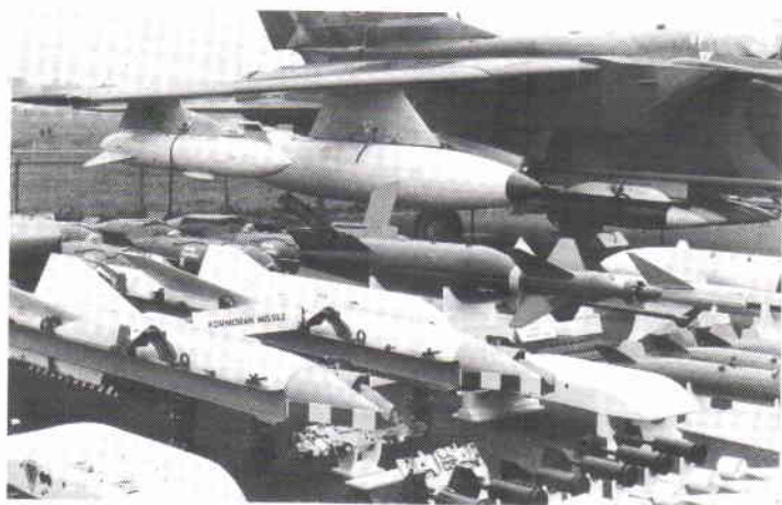
Laserstyrda bomber, attackrobotar, raket, multipelvapen med subtridsdelar, fallskärmsbromsade och slutfasaccelererade vapen förut slagning av bansystem, utgör exempel på beväpningsalternativ för den trinationella attackversionen av Tornado.
