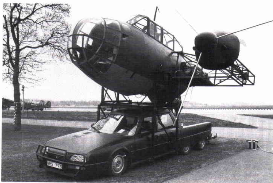
Teves ateljé har byggt denna B18-nos med roterande propeller"blad" av aluminiumrör, monterat på en sexhjulig Citroën, för att spela in flygscener. Fotografen "flyger med" och filmar besättningen i planet.
